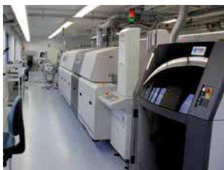
Una delle 5 modernissime linee di caricamento con controllo mediante telecamera
