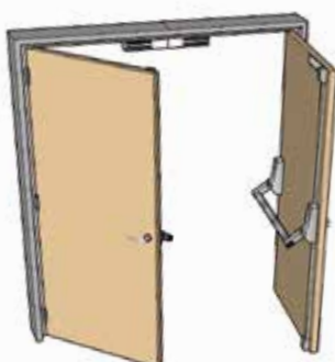
Esempio di applicazione su porta doppia di Uscita di Sicurezza con maniglione antipanico.
